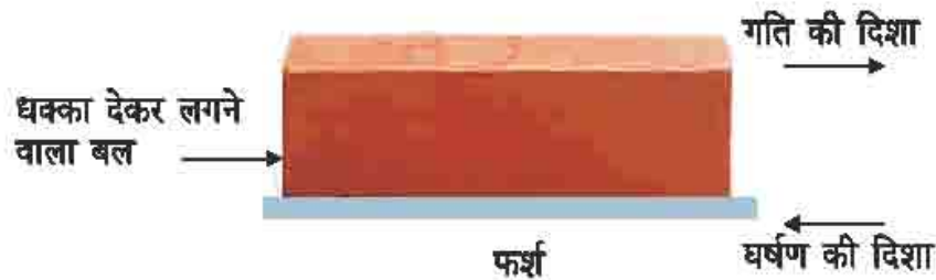
चित्र 7.1 धकेलने पर ईंट पर लगने वाले बल
