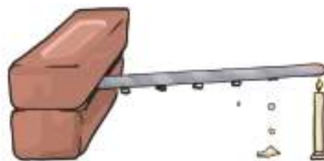
चित्र 3.7 धातु की पत्ती में ऊष्मा के स्थानांतरण का अध्ययन
